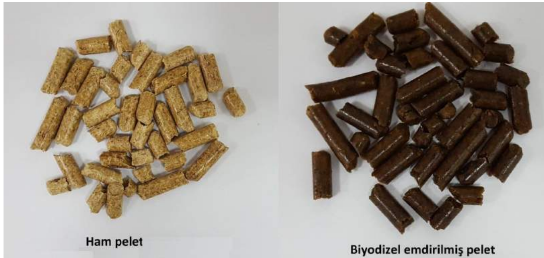
Şekil 3. Ham pelet ve biyodizel emdirilmiş pelet görüntüleri
