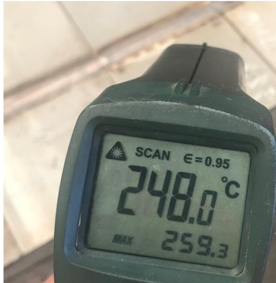
Şekil 8. Lazer termometre ile sıcaklık ölçme.
