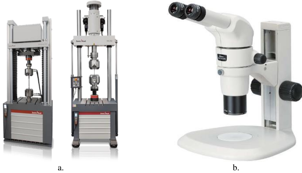
Şekil 9. a. Zwick/Roel Z600 test cihazı, b. Nikon SMZ 800N model optik mikroskop.
